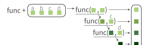
`reduce(x, f, ..., .init)` Aplica una función de forma recursiva a cada elemento de un a lista o vector. También `reduce_right`, `reduce2`, `reduce2_right`. `reduce(x, sum)`
